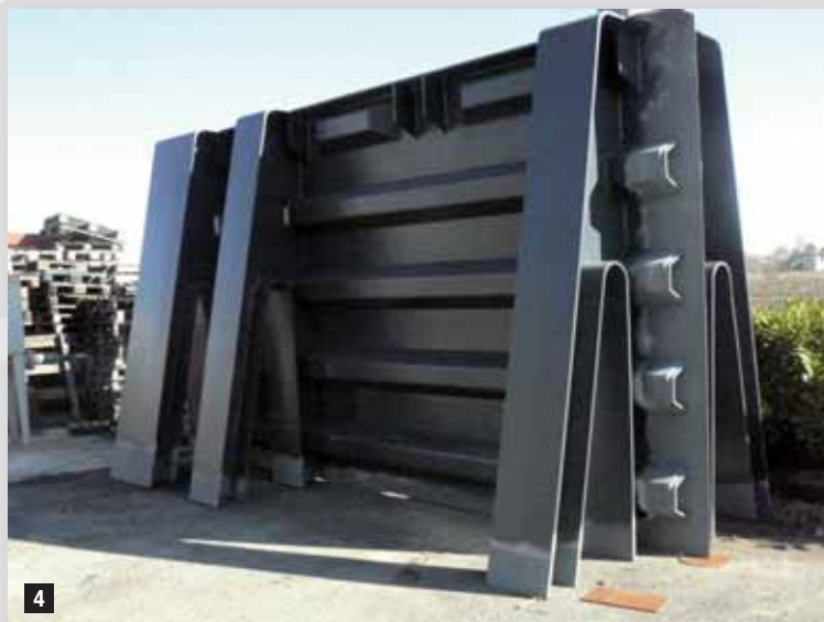
4 Section finished at the factory with welding zones to be sandblasted on site. Concio finito in stabilimento con zone di saldatura da riprendere in cantiere.
